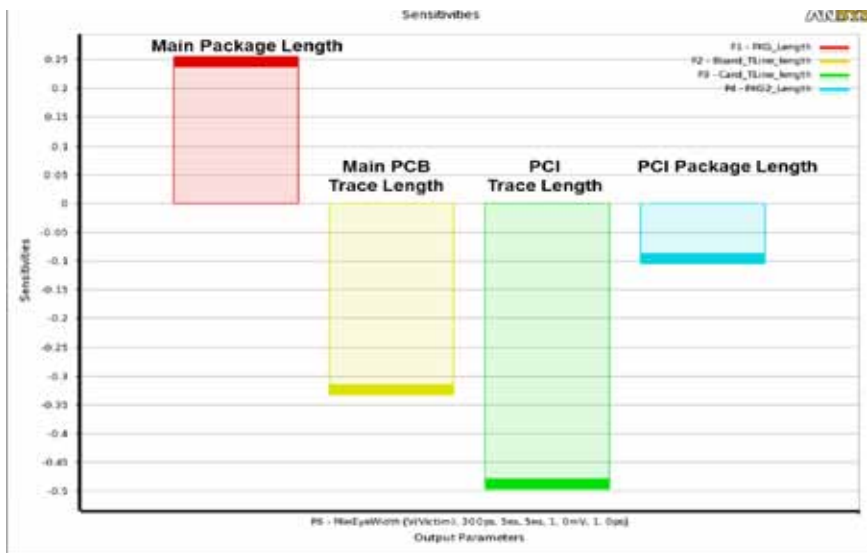
DOE-resultat för flera betydelsefulla parametrar i PCI Express sammanfognings-simuleringar. PCI ledningslängden på periferikortet hade den största negativa verkan på ögonöppningen, följt av längden ledningslängden på huvudkortet.
