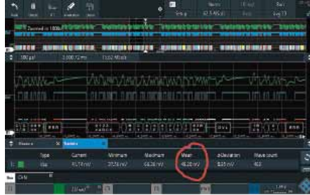
Figur 5. Användande av medelvärdesbildning för att ta bort de delar av rippet som inte orsakas av bitväxling.
