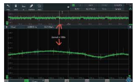
Figur 3. Snabba och långsamma periodiska förlopp kan registreras tack vare ett stort minnesdjup.
