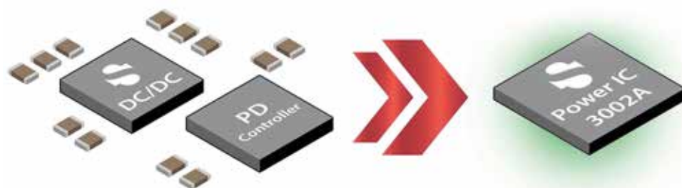
Figur 1. SZPL3002A är en buck-omvandlare med integrerad styrning för USB PD/FC.
