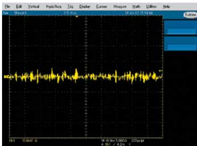
Jordstuds orsakad av överdriven strömförbrukning (och/eller motstånd i strömförsörjningen och jordslingan) kan ge upphov till att jordreferensen hos en krets ändras när strömkraven är höga.
