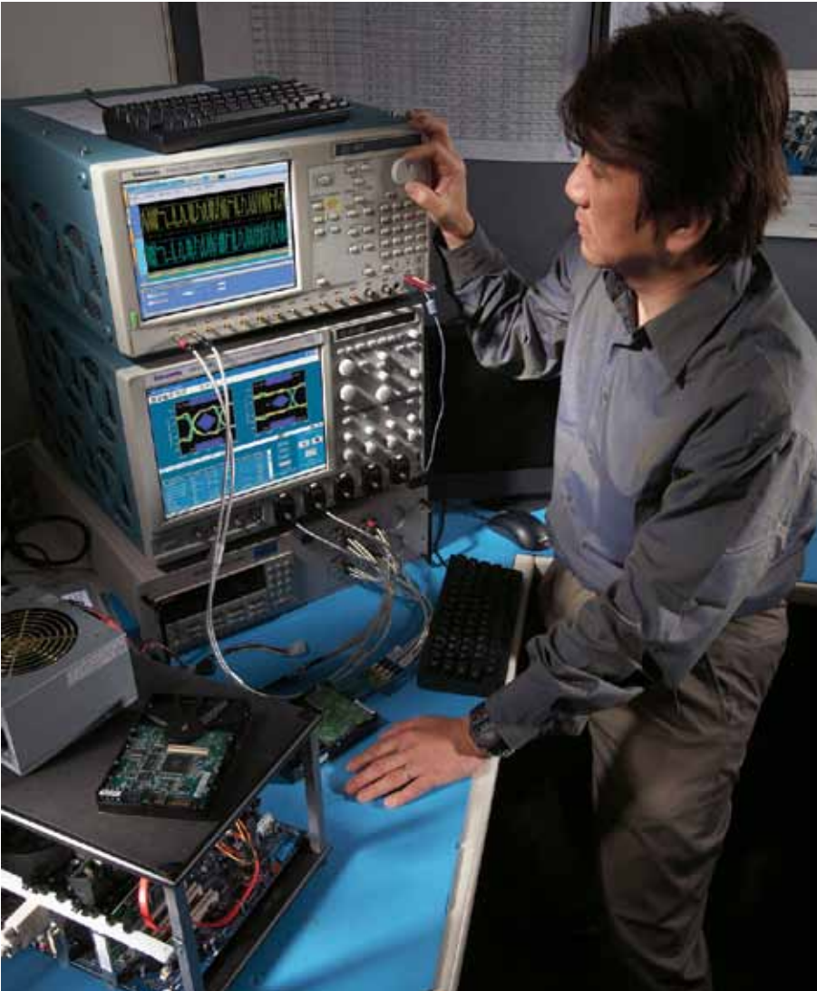
En komplett uppställning för mätning av signalintegritet kan bestå av ett oscilloskop, logikanalysator, realtidspektrumanalysator, tidsdomänsreflektometer, signalgenerator, prober och analysprogram.
