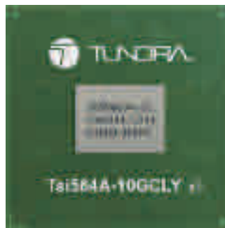
Tundras växelkrets för RapidIO finns nu i mindre storlek för exempelvis mezzaninkort.
